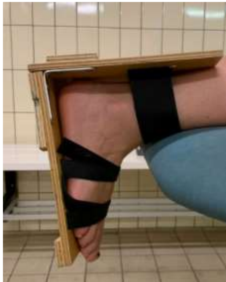
Figure 19 : Système permettant de bloquer la cheville en position neutre
